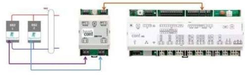
Fig. 57: OpenTherm cascade
