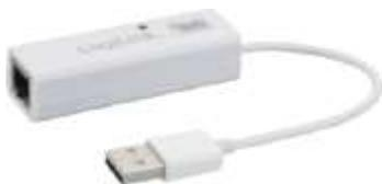
Der **heatapp! USB-LAN Adapter** wird bei der Erstinbetriebnahme der **heatapp! base** und des **heatapp! gateway** benötigt.
