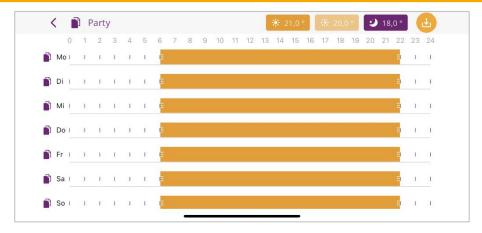
Nach der Auswahl des Raumes öffnet sich das Editierfenster der Schaltzeiten. Default sind Schaltzeiten von 06:00 Uhr bis 22:00 Uhr auf 21° C Wohlfühltemperatur hinterlegt.
