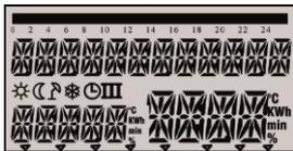
Bei Inbetriebnahme bzw. bei jeder Spannungs-Wiederkehr nach Netzausfall erscheinen für 3 Sek. alle im Display verfügbaren Segmente.
