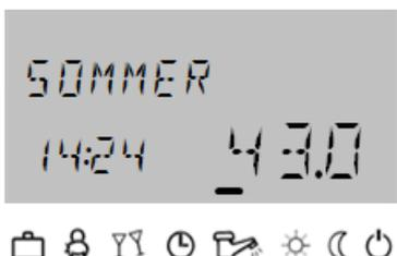
Bei manuellem Sommerbetrieb bleibt nur der Wassererwärmerkreis in Funktion und regelt die Wassererwärmertemperatur nach der vorgegebenem Warmwassertemperatur und vorgegebenem Wassererwärmer-Schaltzeitenprogramm. Der Heizbetrieb wird frostgesichert unterbunden.
