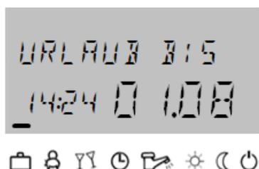
Im Urlaubsbetrieb können die Heizkreise für die Dauer des Urlaubs, je nach Voreinstellung (Heizkreis-Parameter 25), frostgesichert ausgeschaltet oder entsprechend der Einstellungen für Betriebsart REDUZIERT betrieben werden. Warmwasser ist frostgesichert abgeschaltet.
