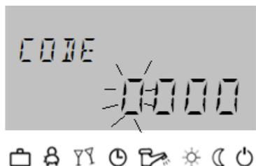
Die jeweils blinkende Stelle kann mit dem Drehknopf entsprechend der Code Zahl eingestellt und durch Antippen der Drehknopfes übernommen werden. Die restlichen Stellen werden in gleicher Weise bearbeitet.
