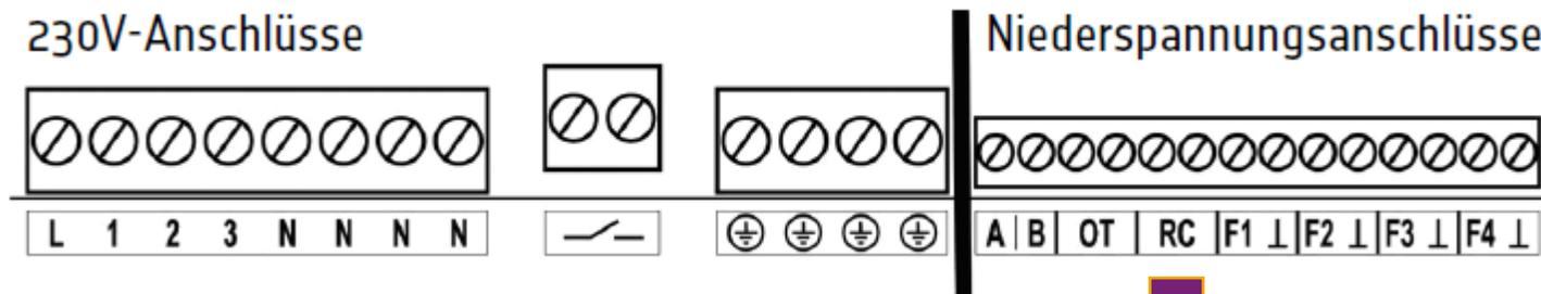
**An den Klemmen RC erfolgt der Anschluss eines Raumgerätes/Fernbedienung CETA-RC.**
